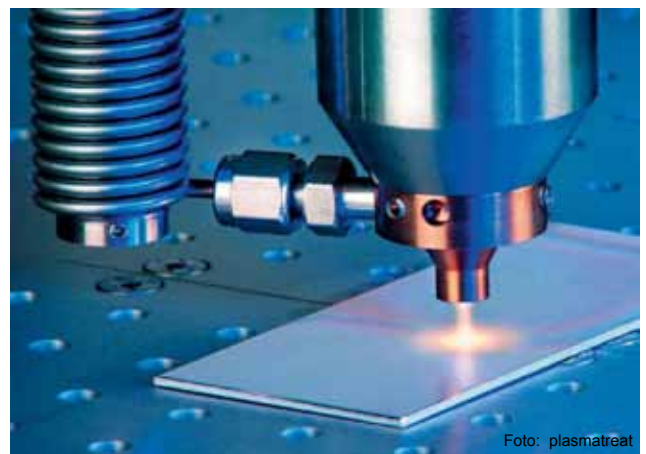
Plasmapolymerbeschichtung eines Aluminiumbleches
