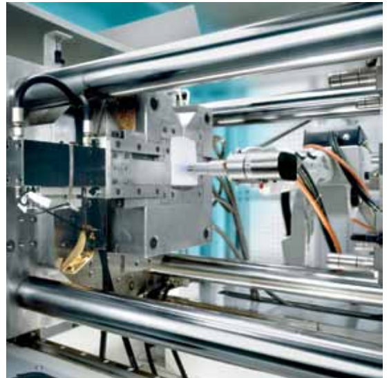
Open-Air® Plasma-Düse, montiert auf 6-Achs-Roboter und eingefahren ins geöffnete Werkzeug
